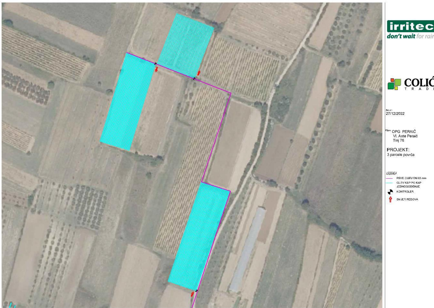
Slika 1.10 Nacrt dijela – položaj glavnog cjevovoda i parcele za uzgoj povrtnih kultura, ARKOD ID: 736899, 737001 i 737123; Izvor: Projekt sustava navodnjavanja za plantažu maslina i povrtnih kultura koji uključuje parcele sa ARKOD ID: 464202, 736920, 3471855, 736899, 737001, 737123. Glavni projekt – građevinsko-tehnološki.
